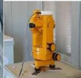
Teodolito Diflux para la medición absoluta de inclinación y declinación magnética
